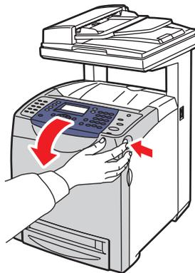
**Warnung:** Manche Komponenten im Drucker, zum Beispiel die Fixiereinheit und der sie umgebende Bereich, können heiß werden, und es besteht Verbrennungsgefahr.
