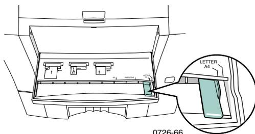
5. После того как передняя панель выведет приглашение **Waiting for Manual Feed** (Ожидание ручной подачи бумаги), вставьте в лоток один лист (или конверт), удерживая его до момента, когда принтер его втянет.
