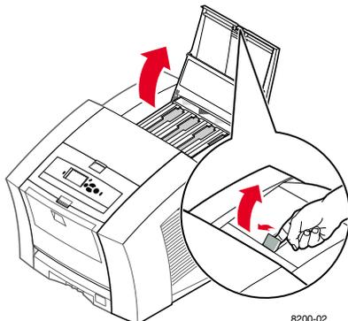
2. Определите ячейку, в которую нужно загрузить чернильный брусок. Метка над каждой ячейкой показывает цвет и номер цвета этого лотка.
