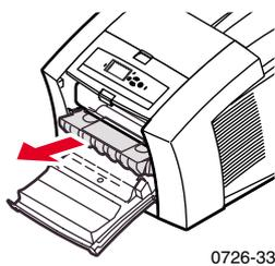
3. Используйте неворсистую ткань, чтобы очистить верх и верхние края подвижного пластикового протирочного устройства, расположенного на ящике обслуживания между валиком и лотком для мусора.
