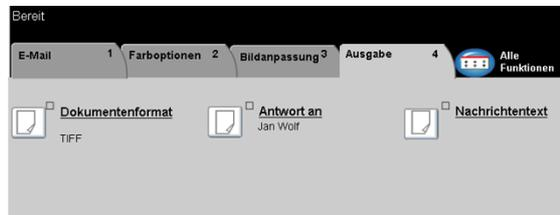
Mit Hilfe dieser Funktion kann die E-Mail-Adresse unter *Antwort an* geändert und das Dateiformat für das gescannte Bild angegeben werden.
