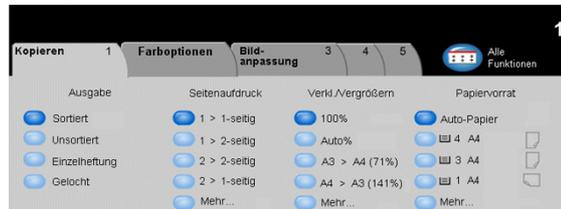
Das Register *Kopieren* ist die Standardanzeige in den Funktionen. Über dieses Register können die Standardfunktionen für einen Kopierauftrag ausgewählt werden.
