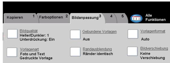
Das Register *Bildanpassung* enthält Kopierfunktionen, mit deren Hilfe das Erscheinungsbild der ausgegebenen Kopie geändert werden kann.
