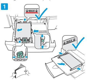
Pour obtenir les meilleurs résultats, ventilez les bords du papier. Réglez les guides papier en fonction du format de papier. Ne chargez pas de papier au-dessus de la ligne de remplissage maximal.
