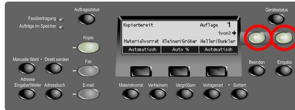
**Schritt 2** – Zum Blättern zu einem anderen Bildschirm die **Pfeiltasten** verwenden. Die Nummer des Bildschirms und die verfügbare Anzahl der Bildschirme werden angezeigt (z. B. **1 von 3**). Der bzw. die Pfeile auf dem Bildschirm zeigen an, in welche Richtung geblättert werden kann (z. B. **nach rechts**).
