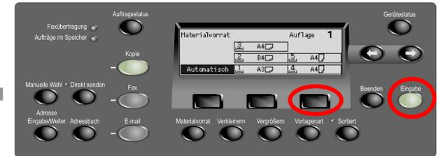
**Schritt 4** – Sobald eine Funktion ausgewählt ist, können die **Pfeiltasten** nicht verwendet werden. Die gewünschte Option erneut mit der **Auswahltaste** wählen. Zum Auf- und Abbewegen in einer Spalte mit Optionen die direkt unter der gewünschten Option stehende **Auswahltaste** drücken (z. B. **dritte Auswahltaste zweimal drücken, um Fax 5 zu wählen**). Auswahl durch Drücken der Taste **Eingabe** abschließen.
