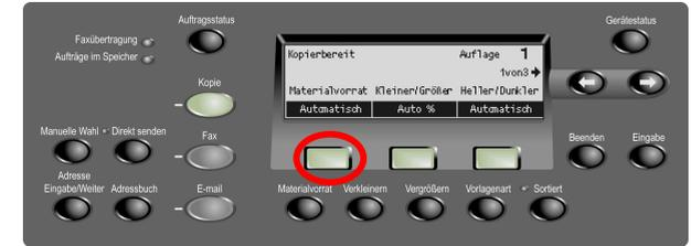
**Schritt 3** – Die direkt unter der gewünschten Funktion stehende **Auswahltaste** drücken (z. B. **Materialvorrat**).
