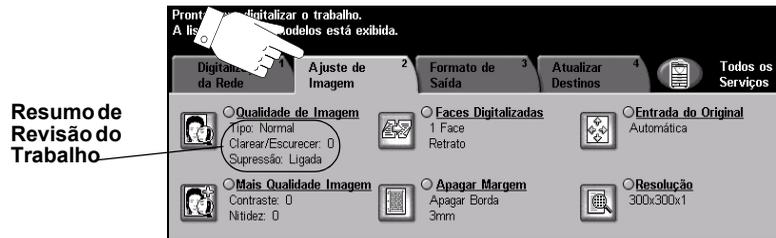
Toque em um dos botões de nível superior para selecionar uma função. Para exibir todas as opções de uma função, selecione a função requerida. Várias opções podem ser selecionadas para cada trabalho de digitalização, se necessário.
