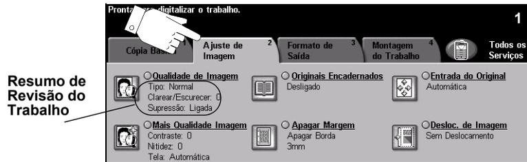
Toque em um dos botões do nível superior para selecionar uma função. Para visualizar todas as opções de uma função, selecione a função requerida. Várias opções podem ser selecionadas para cada trabalho de cópia, se necessário.
