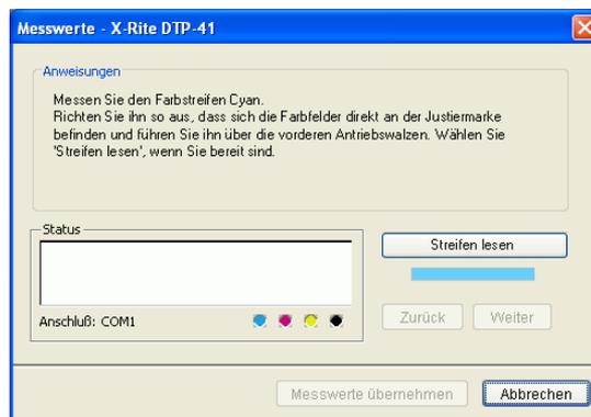
Richten Sie die Messwerteseite so im Führungsschlitz aus, dass der jeweils zu messende Farbstreifen unter der Justiermarke zentriert ist. Führen Sie die Messwerteseite über die vorderen Walzen in das Instrument ein, bis sie an die hinteren Antriebswalzen stößt (etwa 7 cm) und Sie einen Widerstand spüren.
