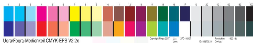
A adição da Cunha de mídia Ugra/FOGRA a qualquer tarefa permite verificar a precisão da cor e a consistência da impressora digital medindo as cores na Cunha de mídia Ugra/FOGRA com o ES-1000 e suportando o software e comparando as medidas com os valores de referência.
