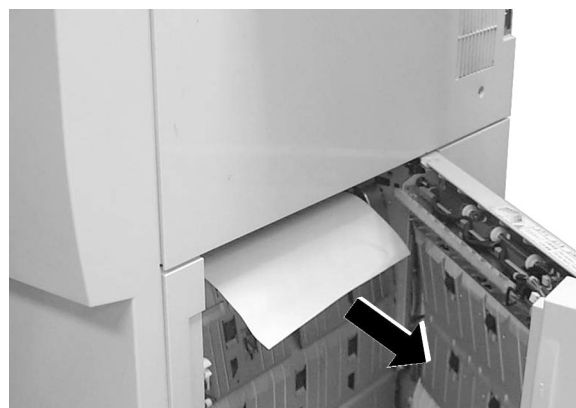
Figura 11: Como remover o papel da parte de trás da Porta Direita da copiadora/impressora
