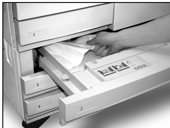
Figur 15: Udredning af papirstop inde i et papirmagasin
