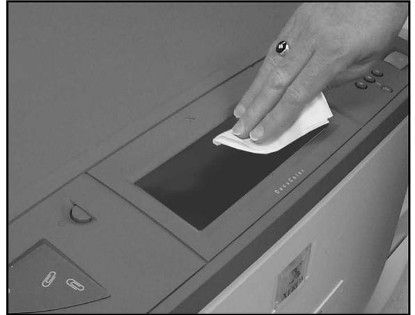
Figure 1 : Nettoyage de l'écran tactile
