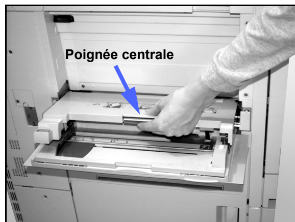
Figure 16 : Dégagement du magasin 5
