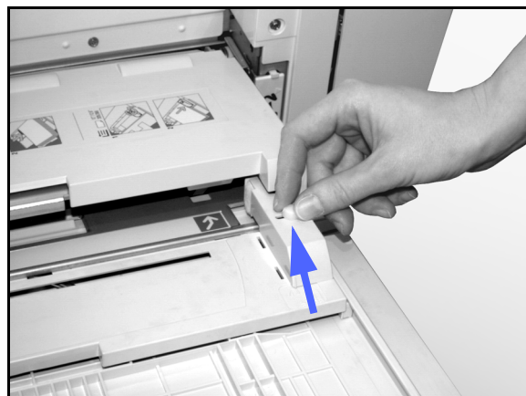
Figure 14 : Guide de format avant et vis de la languette de cadrage
