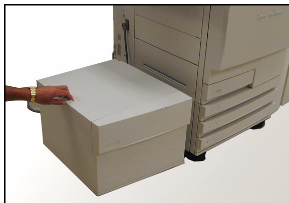
Figure 10 : Dégagement du magasin grande capacité
