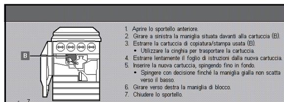
**Fig. 22: Messaggio di sostituzione della cartuccia di stampa**
