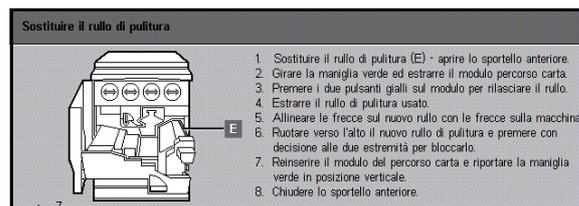
Fig. 36: Messaggio “Controllare rullo di pulitura”
