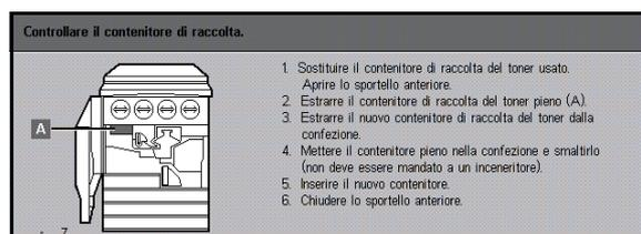
**Fig. 9: Messaggio relativo al contenitore di raccolta del toner usato**
