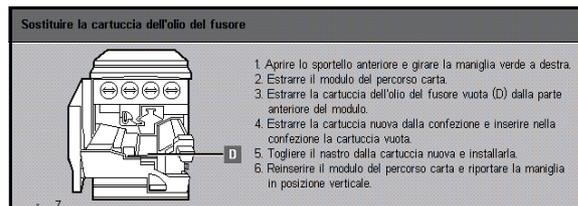
Fig. 29: Messaggio “Controllare l’olio del fusore”
