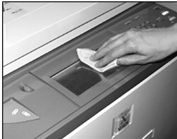
**Figura 1: limpeza da tela de seleção por toque**
