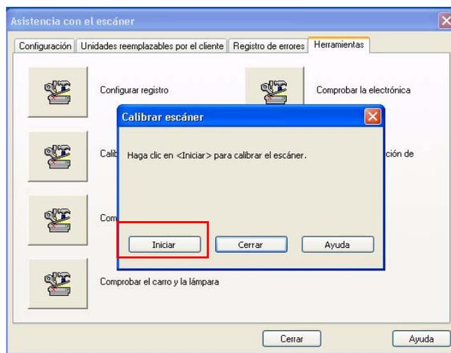
Espera a que el escáner finalice el proceso de calibración antes de usarlo.
