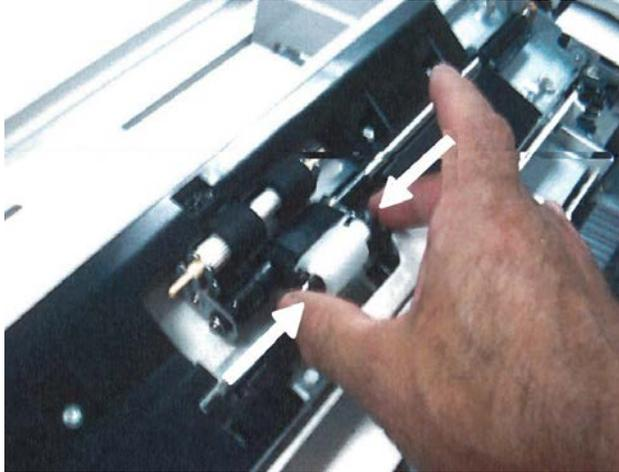
5. Substitua o rolo de retrocesso usando a mesma técnica.
