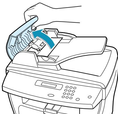
3 Поверните втулку на одном конце роллера АПД в сторону АПД ((a)) и выньте роллер из прорези ((b)). Осторожно вытащите документ вправо и наружу из АПД.
