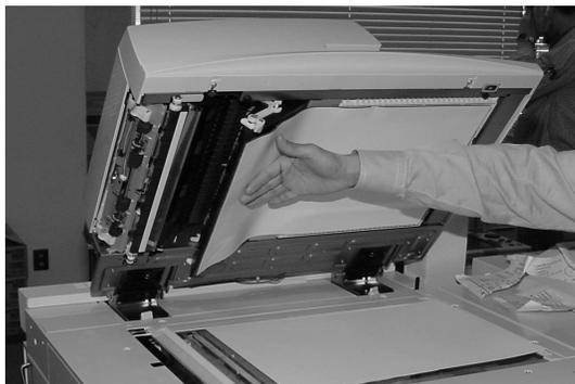
5. Das Spiegelglas, den Metallstreifen, beide Seiten des weißen Plastikstreifens und die Rollen mit einem weichen, mit Wasser befeuchteten Tuch abreiben, dann mit einem weichen Tuch trocken reiben.
