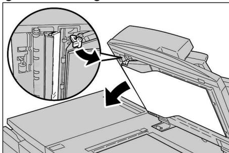
Ein Teil der Vorlagenabdeckung lässt sich von der Vorrichtung weg ziehen, wodurch der Zugang zum Rückseiten-Scanner erleichtert wird.
