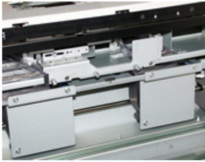
11. Ziehen Sie die 3 Flügelschrauben fest, um die Einheit zu befestigen. Nicht zu fest anziehen.
