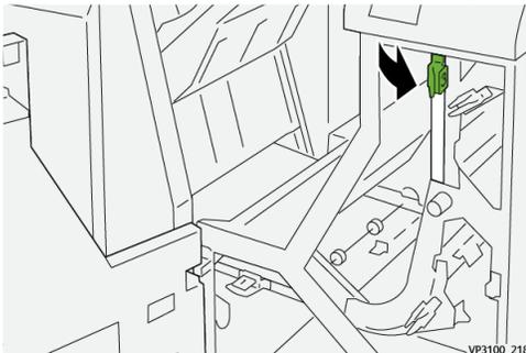
4. Schließen Sie die vordere Abdeckung des Finisher-Transportmoduls.
