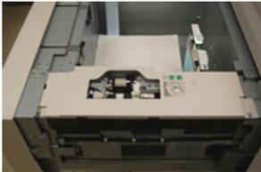
3. Entfernen Sie die Antriebsrolle, indem Sie mit einer Hand auf die schwarze Fläche drücken (dadurch wird die Rolle angehoben) und dann mit einer Hand die Metallwellen an beiden Enden zusammendrücken. Heben Sie die Antriebsrolle heraus.
