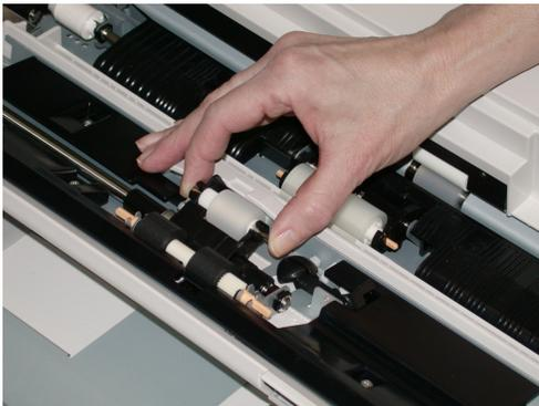
5. Entfernen und ersetzen Sie die Rückhaltewalze auf dieselbe Weise.
