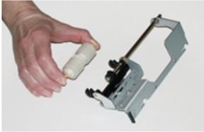
9. Setzen Sie mit derselben Technik eine neue Rückhaltewalze in die schwarzen Kerben der Einheit ein.
