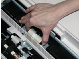
6. Schließen Sie die Abdeckung der Zusatzzufuhr.
