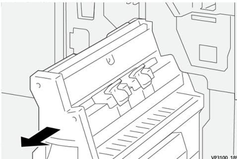
3. Drehen Sie den Knopf **3b** entgegen dem Uhrzeigersinn (①) und entfernen Sie das gestaute Material (②).
