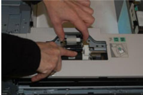
4. Setzen Sie die neue Rolle ein, indem Sie beide Enden der Metallwelle zusammendrücken und gleichzeitig mit der anderen Hand auf die schwarze Fläche drücken, die Rollenenden in die Kerben einsetzen und loslassen.
