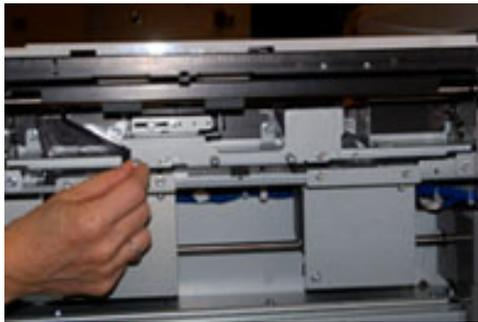
6. Schieben Sie die Rückhalteeinheit ganz nach links und aus den Schlitzen heraus. Die Einheit herausziehen, bis sie vollständig aus dem Fach entfernt ist. Zur Seite legen.
