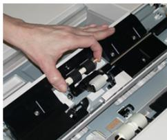
4. Entfernen und ersetzen Sie die Antriebsrolle auf dieselbe Weise.
