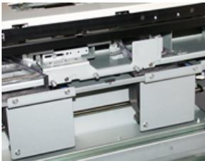
11. Ziehen Sie die 3 Flügelschrauben fest, um die Einheit zu befestigen. Ziehen Sie die Schrauben nicht zu fest.
