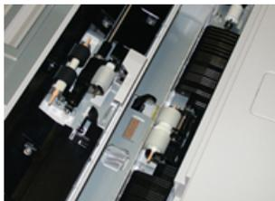
3. Entfernen und ersetzen Sie die Einzugsrolle, indem Sie die Metallwelle zusammendrücken und dann herausheben.
