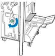
3. Um das Papier zu entfernen, wird es in die gezeigte Richtung gedreht.
