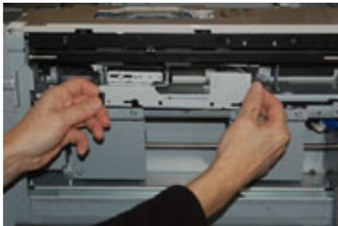
7. Wenn die Rückhalteeinheit entnommen wurde, können Sie auf die Einzugsrolle zugreifen und diese entfernen. Um die Rolle zu entfernen, drücken Sie beide Enden der Metallwelle zusammen und heben Sie sie heraus. Wenn Sie eine neue Rolle einsetzen möchten, drücken Sie beide Enden der Metallwelle zusammen und setzen Sie sie ein. Lassen Sie die Rollenden in die Kerben hineinsinken.
