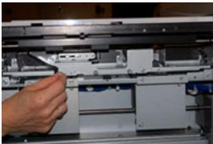
6. Schieben Sie die Rückhalteeinheit ganz nach links und aus den Schlitzen heraus. Ziehen Sie die Einheit heraus, bis Sie sie vollständig vom Fach entfernt haben. Zur Seite legen.
