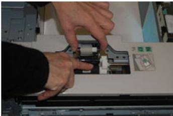
4. Setzen Sie die neue Rolle ein, indem Sie beide Enden der Metallwelle zusammendrücken und gleichzeitig mit der anderen Hand auf die schwarze Fläche drücken, die Rollenden in die Kerben einsetzen und loslassen.
