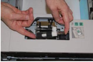
8. Ersetzen Sie schließlich noch die Rückhaltewalze. Drücken Sie die orangefarbenen Wellen der Rückhaltewalze zusammen und heben Sie sie aus der Einheit heraus.
