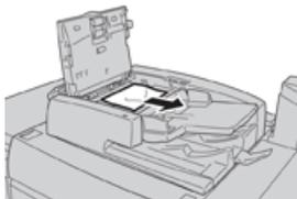
4. Si se le indica que abra la cubierta interna, levante la palanca y abra la cubierta interna. Retire el documento atascado.
