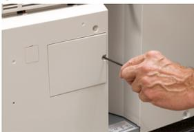
3. Extraiga y separe la cubierta del filtro de succión.
