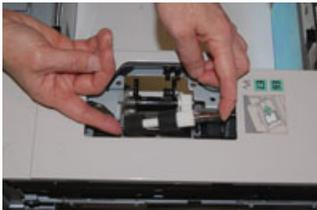
8. Finalement, remplacer le rouleau de retard. Presser les tiges oranges du rouleau de retard et soulever pour le sortir du module.
