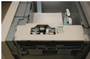
3. Retirer le rouleau d'impulsion en appuyant d'une main sur la languette noire (en soulevant le rouleau) et en pressant les deux extrémités de la tige métallique avec l'autre main. Soulever le rouleau d'impulsion pour le sortir.
