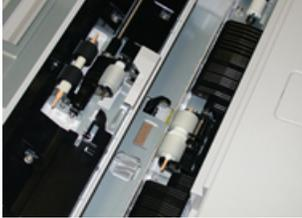
3. Retirer et remplacer le rouleau de départ en pressant les deux extrémités de la tige métallique et en soulevant.
