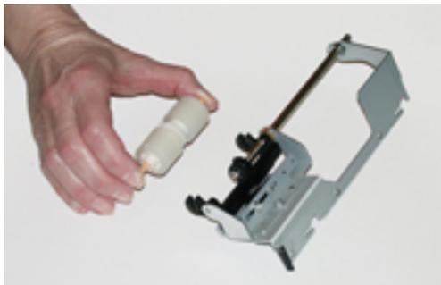
9. Installer un nouveau rouleau de retard dans les encoches noires du module en utilisant la même technique.
