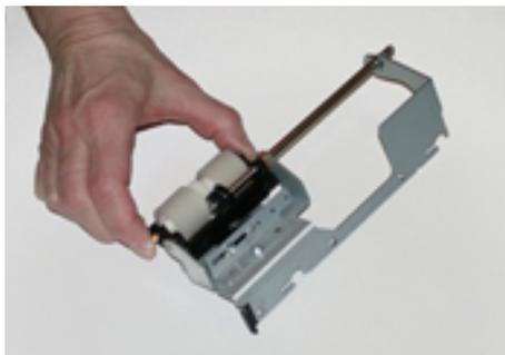
10. Réinstaller le module de retard dans le magasin. Aligner les trous du module avec le cadre du magasin afin que les trous de broches soient jumelés. Insérer le module dans le cadre. Faire glisser le module complètement vers la droite en utilisant la broche comme guide. S'assurer que le dispositif est inséré complètement dans les fentes et que les 3 zones de vis s'alignent.
