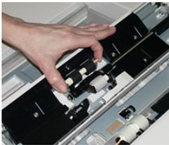
4. Retirer et remplacer le rouleau d'impulsion en utilisant cette même technique.
