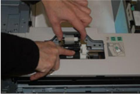
4. Installer le nouveau rouleau : en pressant les deux extrémités de la tige métallique et en appuyant sur la languette noire, insérer et relâcher les extrémités du rouleau dans les encoches.
