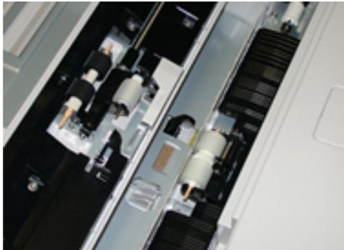
3. Retirer et remplacer le rouleau de départ en pressant les deux extrémités de la tige métallique et en soulevant.
