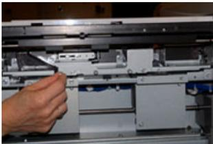
6. Faire glisser le module complètement vers la gauche en dehors des fentes. Tirer le module vers soi jusqu'à ce qu'il soit complètement sorti du magasin. Mettre de côté.
