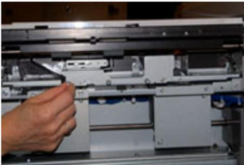
6. Faire glisser le module complètement vers la gauche en dehors des fentes. Tirer le module vers soi jusqu'à ce qu'il soit complètement en dehors du magasin. Mettre de côté.
