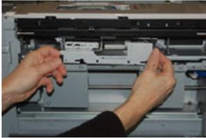
7. Une fois le module sorti, accéder au rouleau de départ pour le retirer. Pour le retirer, presser les deux extrémités de la tige métallique et soulever. Pour installer le nouveau rouleau de départ, presser les deux extrémités de la tige, insérer et relâcher les extrémités dans les encoches.
