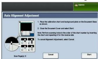
As próximas séries de etapas serão executadas 4 vezes; duas vezes para cada lado do Gráfico de calibração do ajuste de alinhamento que você imprimiu.
