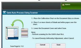
13. Coloque o gráfico de calibração CMYK no Vidro de originais. O gráfico CMYK pode ser reconhecido pela cor amarela no gráfico. Coloque a parte superior do gráfico contra o lado superior do vidro, conforme mostrado na interface com o usuário. Siga as instruções exibidas na interface com o usuário. Certifique-se de cobrir os gráficos com 4 ou 5 folhas em branco para evitar transparência indesejada.
