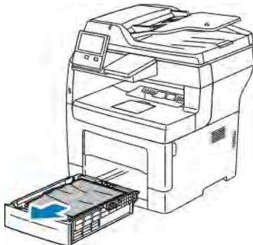
5. Zerknittertes Material aus dem Behälter und ggf. verbliebenes gestautes Material aus dem Drucker entfernen.
