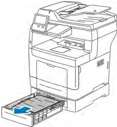
3. Zerknittertes Material aus dem Behälter und gegebenenfalls, verbliebenes gestautes Material vorn aus dem Drucker entfernen.
