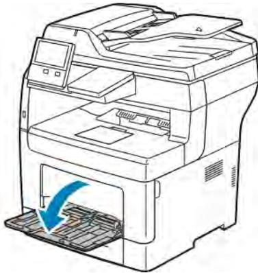
2. Zusatzzufuhr gerade aus dem Drucker herausziehen, um sie aus dem Gerät zu entfernen.
