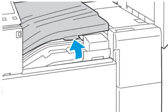
2. Trekk ut avfallsbeholderen for hulling.
