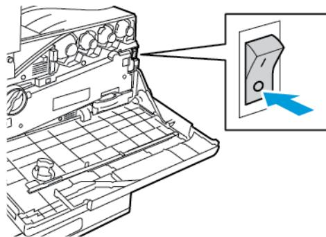
**Forsiktig:** Ikke trekk ut strømledningen mens skriveren slås av. Det kan forårsake skade.
