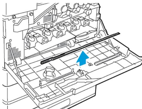
4. Skyv rengjøringsstaven sakte inn i skriveren til den stopper, og trekk den ut igjen. Gjenta dette to ganger til.
