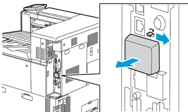
**Forsiktig:** Trekk ikke for hardt i den trådløse nettverksadapteren. Hvis du har brukt utløserhendelen riktig, vil adapteren lett komme ut. Hvis du trekker hardt i adapteren, kan du skade den.
