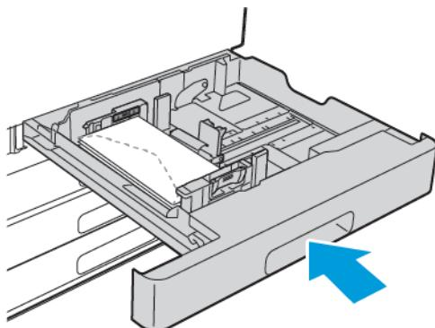
4. Velg papirformat, -type og -farge på kontrollpanelet. Pass på at papirtypen er stilt inn på Konvolutt.
