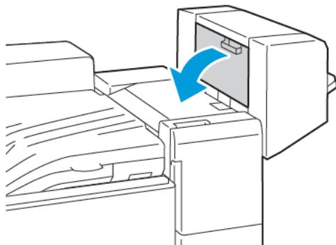
2. Hvis stiftekassettene ikke er synlige, griper du de vertikale panelene til venstre og høyre for åpningen og skyver panelene mot midten.
