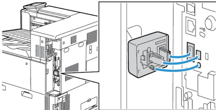
**Forsiktig:** Hvis du trekker hardt i adapteren, kan du skade den. Når adapteren er installert, må du følge instruksjonene for fjerning av trådløs nettverksadapter hvis du har behov for å fjerne den. Se [Demontere den trådløse nettverksadapteren](#) hvis du vil ha mer informasjon.
