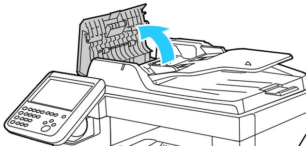
2. Начисто протрите ролики подачи и разделительную подкладку чистой безворсовой тканью, смоченной водой.
