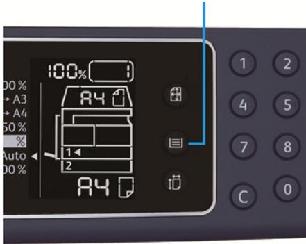
En el diagrama de estado de la máquina se enciende el indicador luminoso de la bandeja seleccionada y aparecen el tamaño y la orientación en el visor de tamaño de papel.
