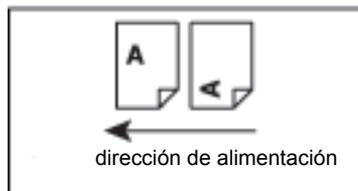
Colocación del documento o papel con orientación vertical mirando desde la parte delantera de la máquina.
