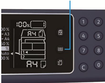
Sur le diagramme d'état de la machine, le voyant de bac s'allume au niveau du bac sélectionné. Son format de papier et son orientation sont affichés sur la zone d'affichage du format du papier.
