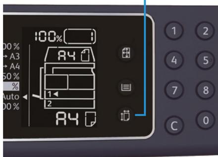
Le format clignote dans la zone d'affichage; la machine entre dans le mode de paramétrage du format de papier.
