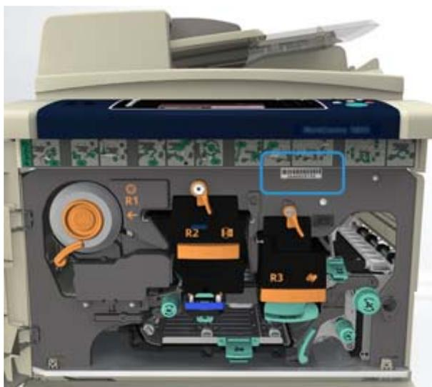
1. Die Seriennummer ist an der Druckerinnenseite angegeben. Die vordere Abdeckung öffnen. Über dem Fixiermodul ist ein Schild mit der Seriennummer angebracht.
