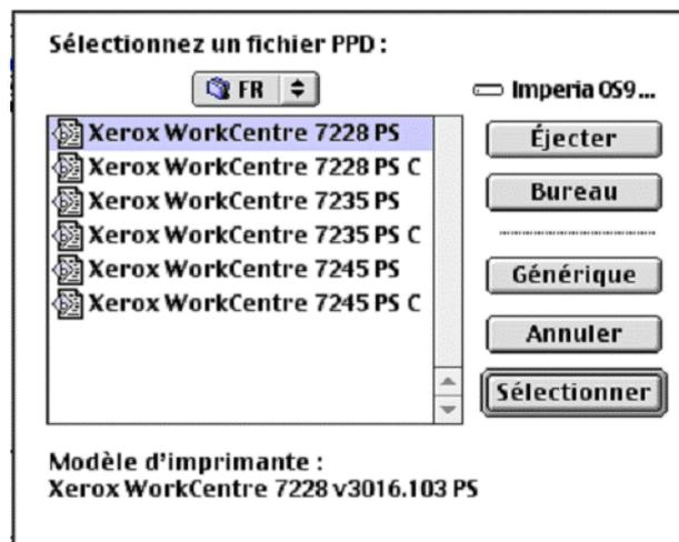
**REMARQUE :** Lorsque le module de finition C ou le module de finition C avec bac de réception cahier est installé, sélectionner le numéro de modèle se terminant par un C.
