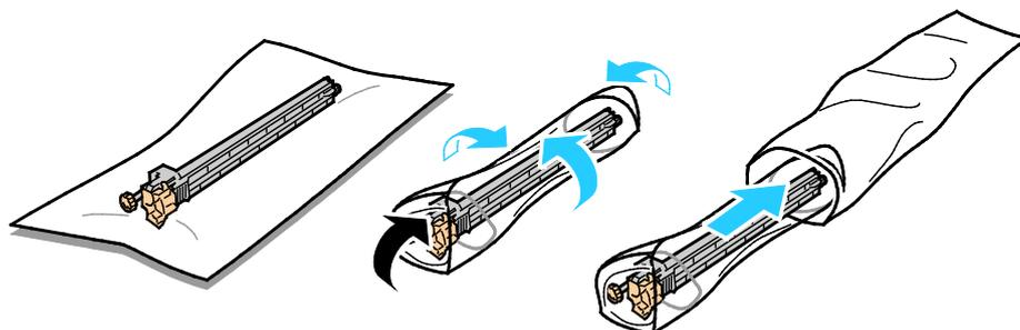
7. Retirez l'enveloppe protectrice du nouvel élément de nettoyage.
