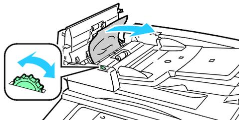
4. Si le message vous demande d'ouvrir le capot intérieur, soulevez le levier avec la languette verte pour ouvrir le capot intérieur.
