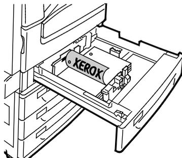
**Remarque :** Ne chargez pas de papier au-dessus de la ligne de remplissage maximal. Une surcharge du magasin risque d'entraîner des incidents papier dans l'imprimante.
