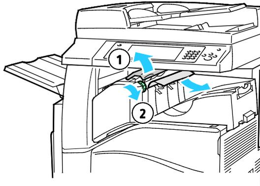
5. Fermez le capot supérieur du module de finition intégré.
