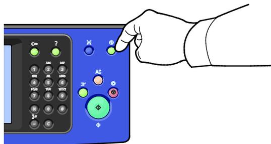
2. Pour enlever les traces de doigts et les taches, nettoyez l'écran tactile et le panneau de commande à l'aide d'un chiffon doux non pelucheux.
