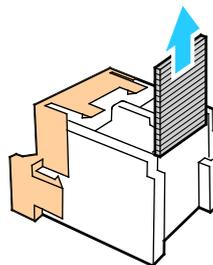
5. Saisissez les languettes sur les deux côtés de la nouvelle cartouche d'agrafes et insérez-la dans la position originale dans le module de finition.
