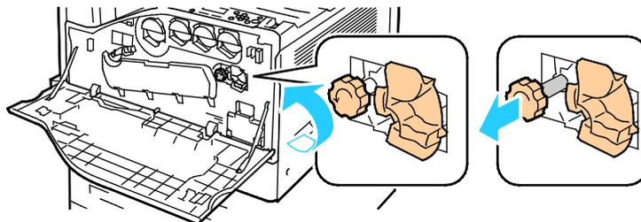
4. Sortez complètement l'élément de nettoyage de la courroie de transfert de l'imprimante.
