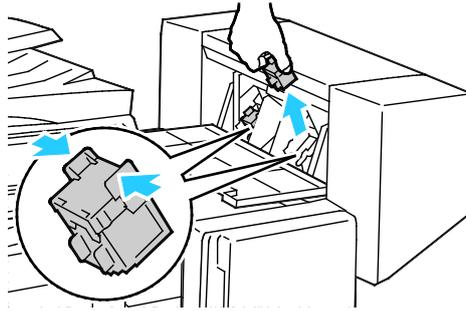
4. Saisissez les languettes sur les deux côtés de la nouvelle cartouche d'agrafes et insérez-la dans la position originale dans le module de finition.
