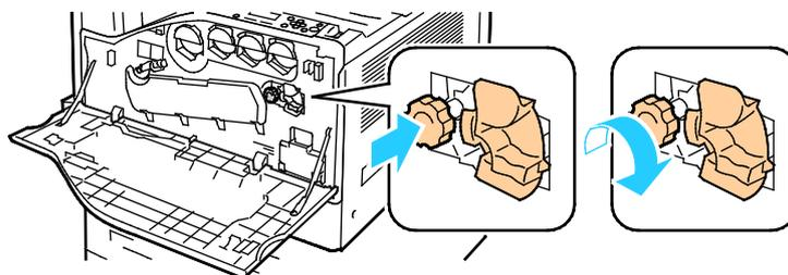
10. Tournez le levier orange sur la gauche pour verrouiller l'élément de nettoyage de la courroie.
