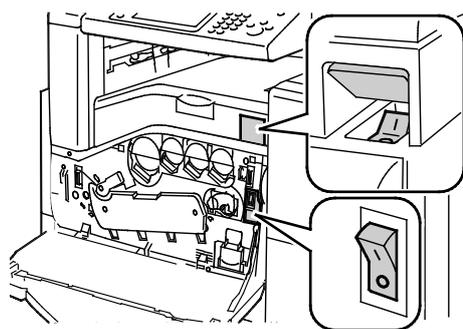
Interrupteurs d'alimentation avec module de finition OfficeTray
