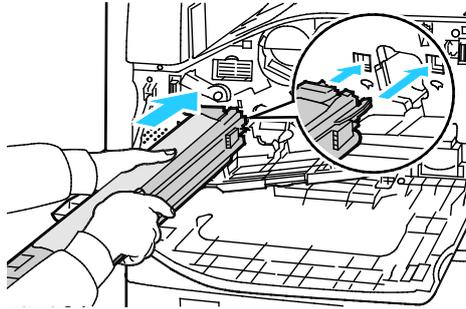
5. Tout en laissant les guides insérés dans le logement, retirez la feuille de papier noire en tirant dessus dans la direction indiquée.
