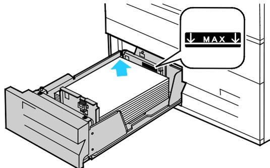
4. Réglez les guides pour les mettre légèrement en contact avec les bords de la pile.
