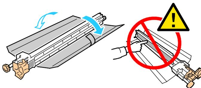
8. Tenez l'élément avec la main gauche et faites-le glisser directement dans son logement jusqu'à la butée.
