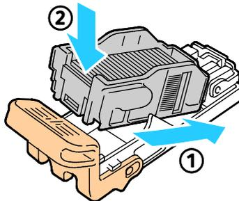
6. Pour insérer la cartouche d'agrafes dans le module de finition intégré, saisissez la cartouche d'agrafes par la poignée orange et insérez-la dans l'agrafeuse jusqu'à ce qu'elle s'enclenche.
