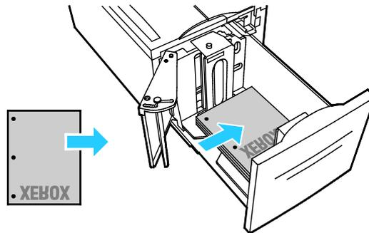
**Remarque :** Ne chargez pas de papier au-dessus de la ligne de remplissage maximal. La surcharge de papier peut entraîner des incidents.
