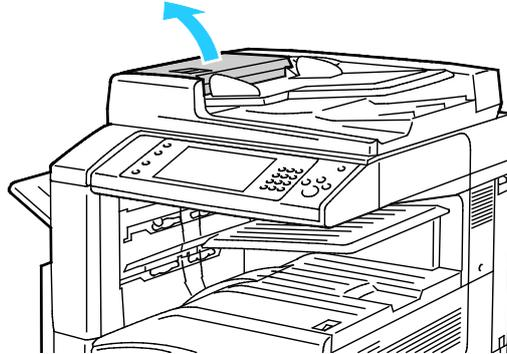
2. Faites tourner les rouleaux et essuyez-les à l'aide d'un chiffon propre, non pelucheux et imbibé d'eau.
