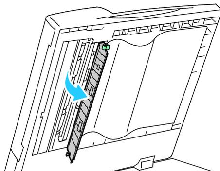
3. À l'aide d'un chiffon doux humecté d'eau, essuyez la vitre miroir, la bande métallique, les deux côtés de la bande plastique blanche et les rouleaux. Si la saleté résiste, humectez un chiffon doux avec une petite quantité de détergent neutre. Essuyez ensuite avec un chiffon sec.
