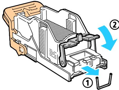
6. Pour insérer la cartouche d'agrafes dans le module de finition intégré, saisissez la cartouche d'agrafes par la poignée orange et insérez-la dans l'agrafeuse jusqu'à ce qu'elle s'enclenche.
