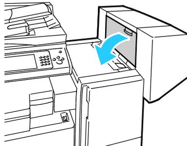
2. Si les cartouches d'agrafes ne sont pas visibles, saisissez les capots verticaux à gauche et à droite de l'ouverture et faites-les glisser vers le centre.
