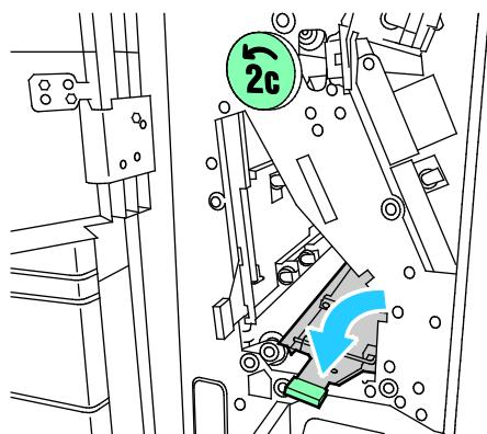
5. Zavřete příhrádku jednotky a poté zavřete přední dvírka jednotky pro skládání ve tvaru CZ.
