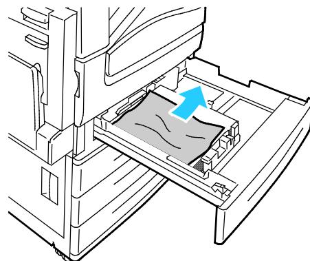
5. Vložte do zásobníku nový nepoškozený papír a poté zásobník zasuňte až na doraz. Na ovládacím panelu se zobrazí hlášení Paper Settings - Tray X (Nastavení papíru - zásobník X).
