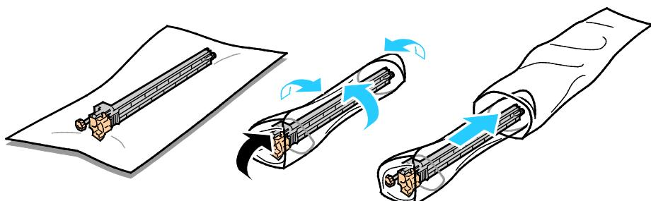
7. Odstraňte z nového čističe přenosového pásu ochranný kryt.
