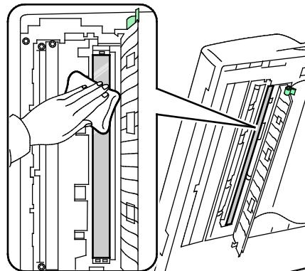
4. Vraťte kryt předloh do původní polohy a ověřte, že páčka zapadla na místo. Pokud jste se dotkli krytu předloh holýma rukama, před zavřením podavače předloh kryt vyčistěte.
