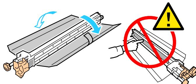
8. Podepřete nový čistič přenosového pásu levou rukou a rovně ho zasunujte do otvoru, dokud se nezastaví.
