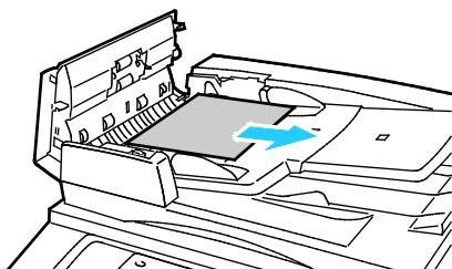
3. Pokud najdete v hlášení na ovládacím panelu pokyn, abyste otočili zeleným kolečkem, otočte jím ve vyznačeném směru. Otáčením zeleným kolečkem vysunete předlohu z podavače.
