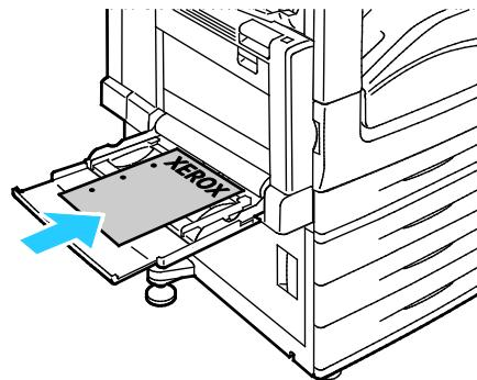
**Poznámka:** Nevkládejte papír nad rysku maximálního naplnění. Při přeplnění zásobníku může dojít k zaseknutí médií v tiskárně.
