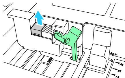
3. Aktivujte blok jemného nastavení stisknutím páček a posunutím zámků vodítka doleva podle obrázku.
