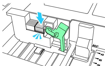
5. Vložte papír s uživatelským formátem do zásobníku. Vodítka v zásobníku se posouvají v krocích po 1 mm.
