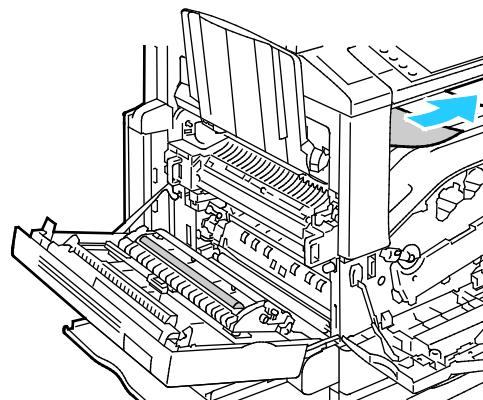
7. Pokud uvázne papír ve fixační jednotce, zatáhněte za zelenou páčku A1 a otevřete branku fixační jednotky.
