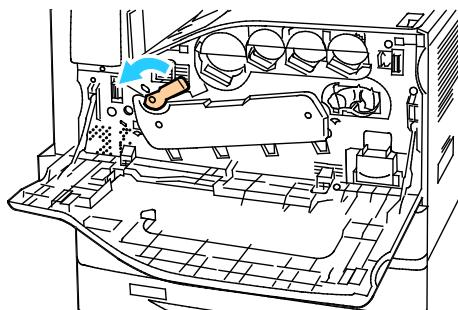
3. Stáhněte kryt tiskové jednotky dolů tak, aby zaklapla na místo do otevřené pozice.
