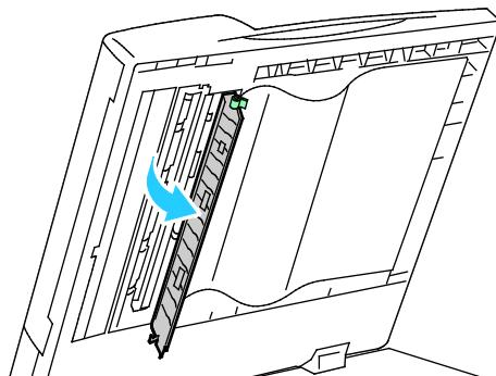
3. Měkkým hadříkem navlhčeným ve vodě otřete zrcadlové sklo, kovový proužek, obě strany bílého plastového proužku a válečky. Pokud je nečistoty obtížné odstranit, navlhčete měkký hadřík v malém množství neutrálního čisticího prostředku. Potom tyto součásti otřete do sucha měkkým hadříkem.
