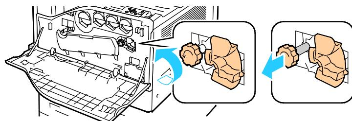
4. Vytáhněte čistič přenosového pásu rovně z tiskárny.
