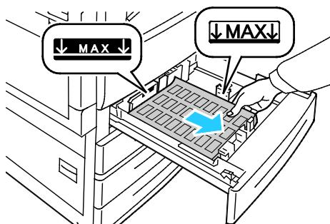
3. Pro podávání kratší stranou vložte štítky tiskovou stranou nahoru a horním okrajem směrem doprava.
