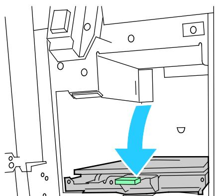
5. Zavřete přední dvírka jednotky pro skládání ve tvaru CZ.
