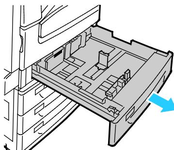
2. Přesvědčte se, že jsou zámky vodítek nastaveny ve správné poloze pro formát štítků, které vkládáte. Podrobnosti najdete v části [Nastavení zámku vodítek v nastavitelných zásobnících na 500 listů](#) na straně 63.
