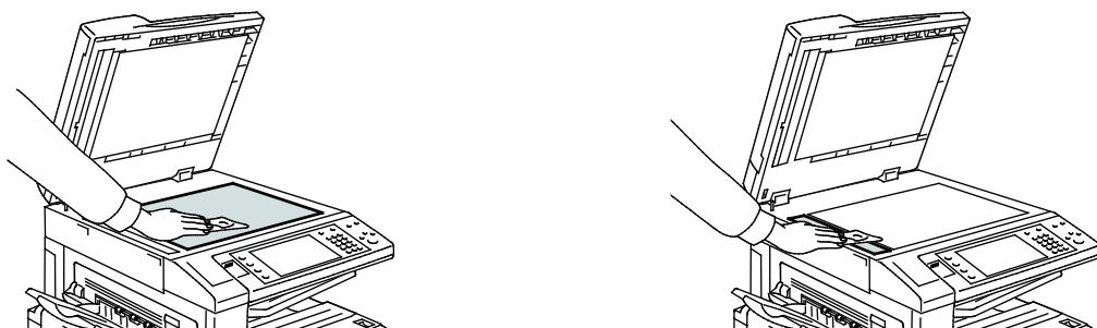
2. Spodní část krytu předloh a podavače předloh čistěte hadříkem, který nepouští vlákna, a čisticím roztokem Xerox® Cleaning Fluid.
