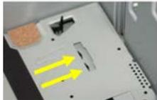
6. Die Rändelschraube festziehen, so dass sie die Postkarten-Halterung sichert.
