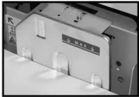
Das Material muss in Längsseitenzufuhr (LSZ)/Hochformat eingelegt werden.
