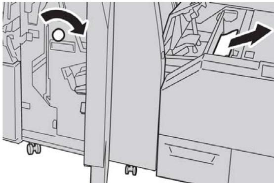
5. Die linke Abdeckung der Trimmer-Einheit schließen.
