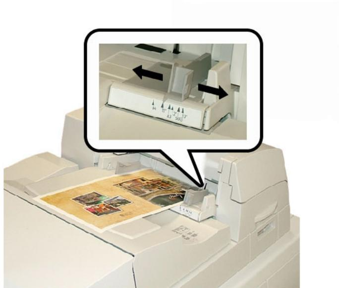
4. À partir de la fenêtre Propriétés du magasin sur l'interface utilisateur, saisir les informations correctes pour le support, y compris le format, le type et le grammage.
