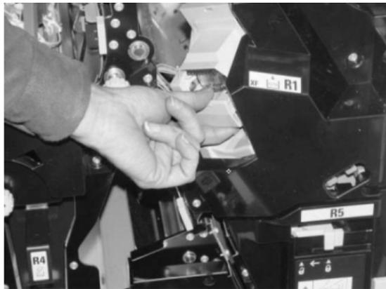
4. Vérifier si des agrafes se trouvent à l'intérieur du module de finition et, si nécessaire, les enlever.
