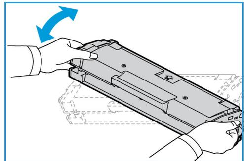
5. Tenere la nuova cartuccia di stampa per la maniglia ed inserirla lentamente nella macchina. Le linguette ai lati della cartuccia e le scanalature corrispondenti all'interno della macchina guideranno la cartuccia nella posizione corretta finché non si blocca in posizione.
