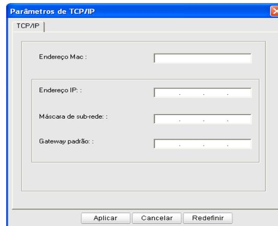
6. Clique em **Aplicar** e depois em **OK**. O equipamento imprimirá automaticamente o **Relatório de configuração de rede**. Confirme se todas as configurações estão corretas.
