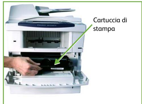
**i** Se, dopo l'installazione di una nuova cartuccia di stampa, la copertura anteriore non si chiude, controllare che la cartuccia sia posizionata e agganciata correttamente.
