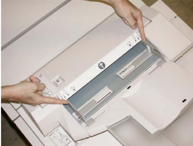
3. Material/Registriermaterial einlegen und an der Behältervorderseite ausrichten.
