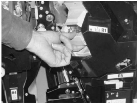
4. Falls erforderlich das Heftklammermagazin öffnen und die gestaute Heftklammer entfernen.
