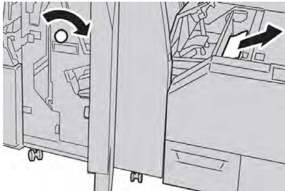
5. Die linke Abdeckung der Trimmer-Einheit schließen.
