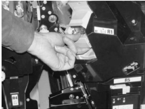
4. Se necessário, abra a unidade de cartucho de grampos conforme mostrado e remova o grampo atolado.
