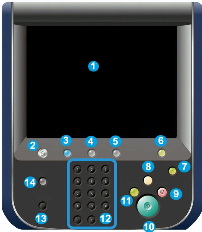
1. **Tela de Seleção por Toque.** A tela de seleção por toque permite selecionar todas as funções de programação disponíveis. Ela também exibe procedimentos de eliminação de falha e informações gerais sobre a máquina.
