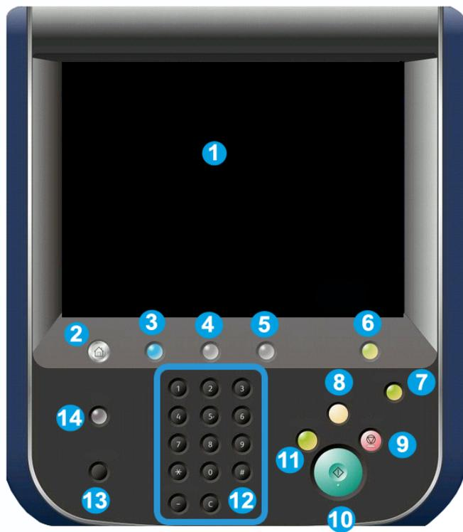
1. **Сенсорный экран.** Сенсорный экран служит для выбора функций при программировании аппарата. На нем также выводятся указания по устранению неисправностей и общие сведения об аппарате.
