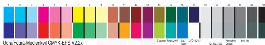
Associée à une tâche, cette gamme permet de contrôler la précision et la régularité des couleurs de la presse numérique en les mesurant à l'aide de l'ES-1000 et du logiciel associé, et en comparant les résultats avec des valeurs de référence.
