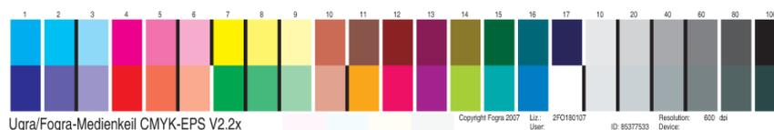
A adição da cunha de mídia Ugra/Fogra a qualquer tarefa permite verificar a precisão da cor e a consistência da impressora digital medindo as cores na cunha de mídia Ugra/Fogra com o ES-1000 e suportando o software e comparando as medidas com os valores de referência.
