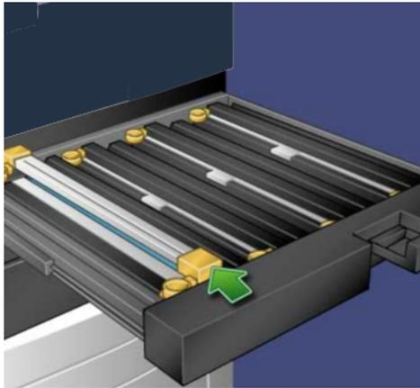
8. Das alte Ladekorotron an den beiden orangefarbenen Endstücken greifen und vorsichtig gerade nach oben aus dem Gerät heben.
