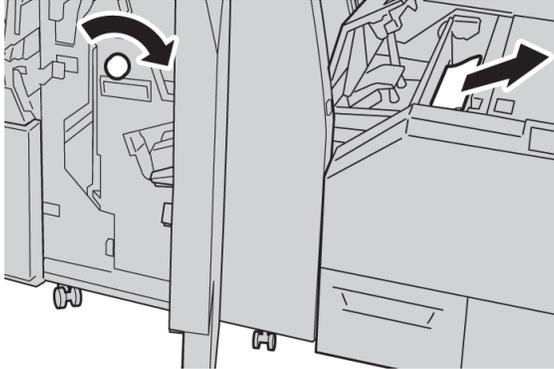
5. Die linke Abdeckung der Trimmer-Einheit schließen.
