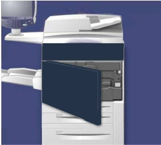
2. **Griff 2** nach rechts drehen, bis er horizontal steht, und dann das Transfermodul herausziehen.
