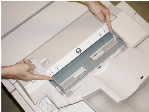
3. Material/Registermaterial einlegen und an der Behältervorderseite ausrichten.
