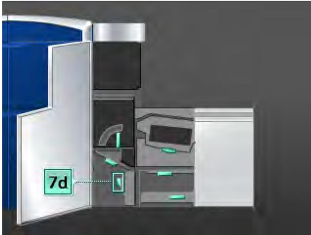
9. Use un paño sin pelusa humedecido con agua (no mojado), para limpiar el recorrido del papel sólo en las áreas de despeje de atascos de la palanca verde como se muestra en la ilustración.
