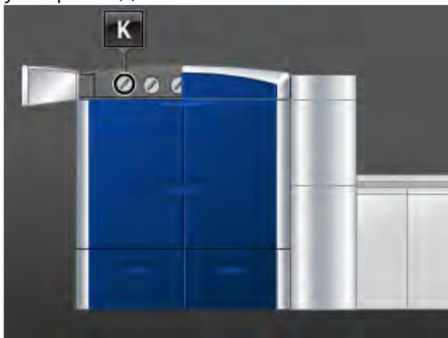
3. Gire el cartucho a la posición de no asegurado, como se indica en la siguiente ilustración.
