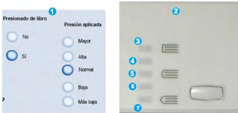
1. Opciones de plegado cuadrado/creación de libros que se muestran en la IU de la máquina; la ilustración que se muestra es solamente una representación. Las imágenes reales en la IU de la máquina pueden variar según la máquina a la cual esté conectada.
