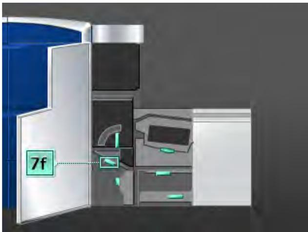
6. Use un paño sin pelusa humedecido con agua (no mojado), para limpiar el recorrido del papel sólo en las áreas de despeje de atascos de la palanca verde como se muestra en la ilustración.
