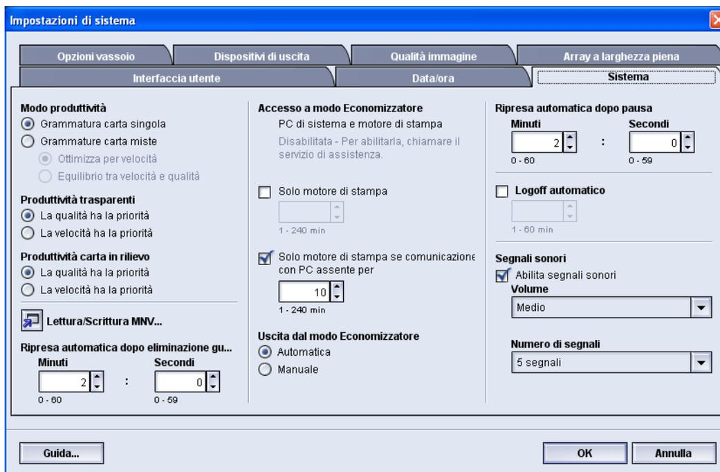
Il contatore si avvia quando tutti i guasti sono stati eliminati dalla macchina. Al termine dell'intervallo di tempo specificato, la stampa riprenderà automaticamente.
