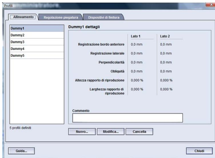
La funzione Allineamento consente di creare e salvare profili di allineamento specifici che consentono di utilizzare tipi di supporti diversi e definire il modo in cui registrare, allineare o ingrandire l'immagine per il lato 1 e 2. È possibile inoltre utilizzarli quando se ne ha la necessità, al fine di assicurare la qualità di stampa ottimale.
