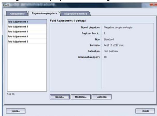
È inoltre possibile regolare le posizioni di piegatura per Piegatura doppia un foglio; Piegatura doppia più fogli; Piegatura doppia più fogli, pinzatura; Piegatura a C; Piegatura a Z e Piegatura a Z metà foglio.
