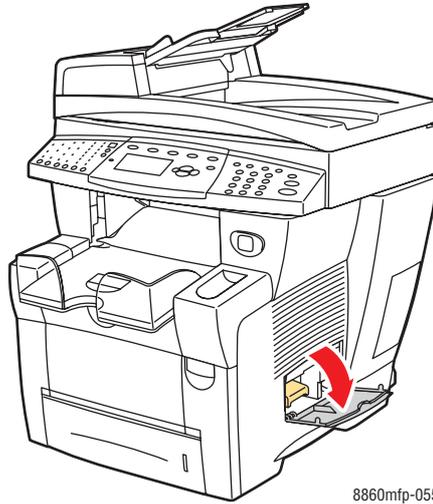
2. Remova o kit de manutenção (A) e coloque-o em um saco plástico para armazenamento.
