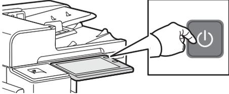
Zur Inbetriebnahme des Druckers auf dem Steuerpult die **Betriebstaste** drücken.
