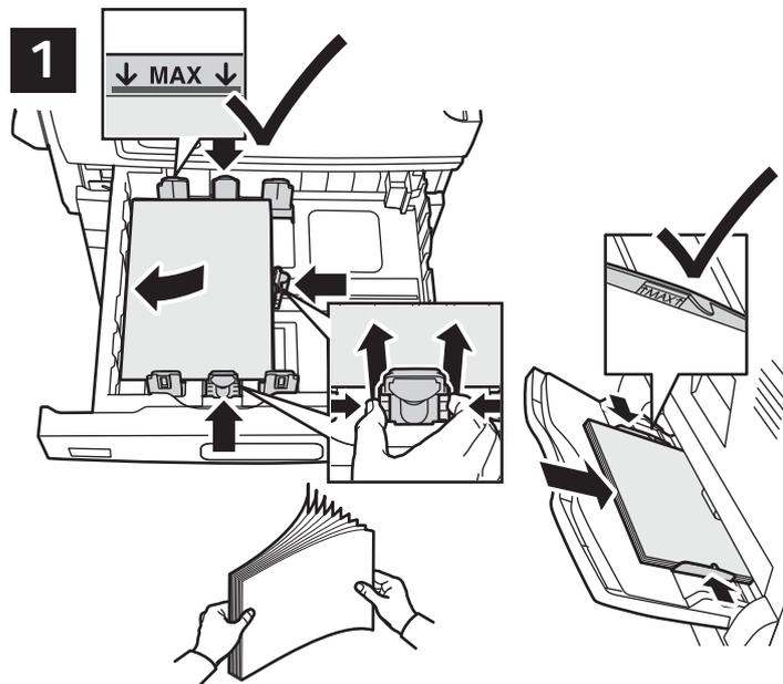
Um bestmögliche Ergebnisse zu erzielen, das Papier auffächern. Die Führungen auf das Materialformat einstellen. Die Markierung für die maximale Füllhöhe nicht überschreiten.
