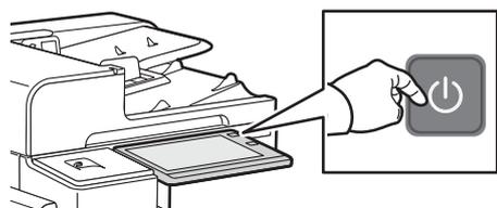
Для включения принтера нажмите **выключатель питания**.
