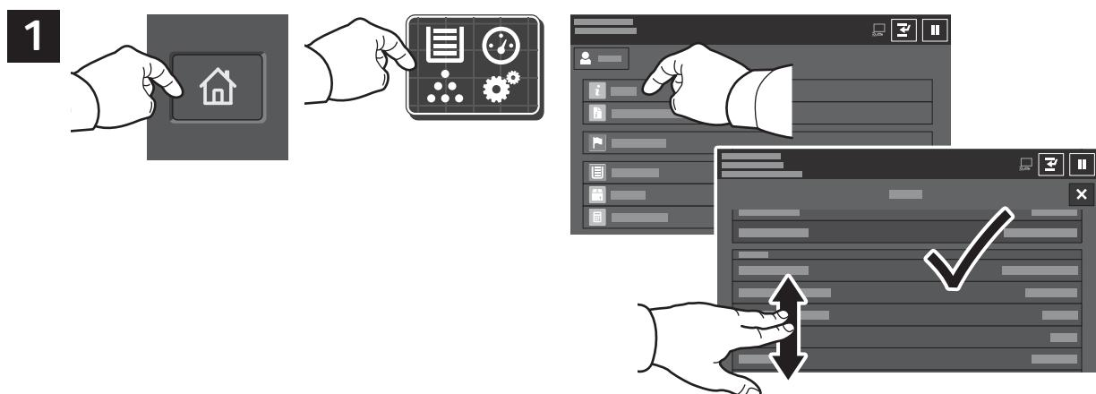
Zabeležite naslov IP tiskalnika, ki se prikaže na zaslonu na dotik. Če se naslov IP ne pojavi v zgornjem levem kotu zaslona na dotik, pritisnite tipko Home (Domov), se dotaknite možnosti **Device** (Naprava) > **About** (Več o tem) in nato podrsajte do naslova IP.
