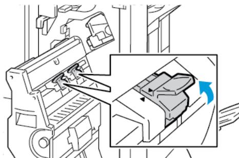
9. Remettez la plieuse/brocheuse dans sa position d'origine, puis fermez le panneau du module de finition.
