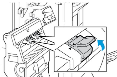
10. Remettez la plieuse/brocheuse dans sa position initiale, puis fermez la porte du module de finition.
