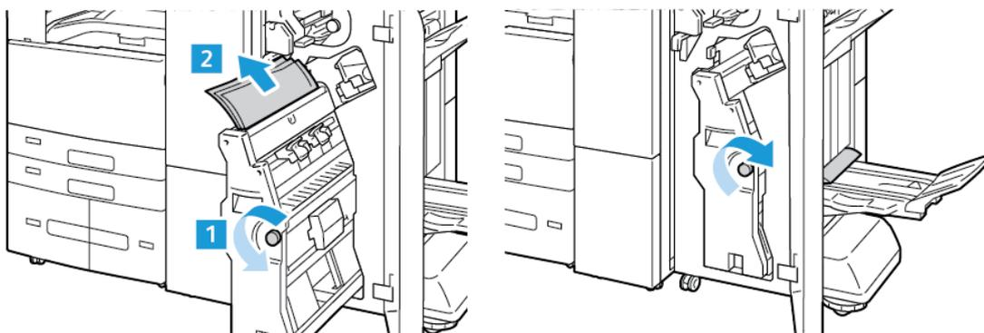
4. Remettez la plieuse/brocheuse dans sa position d'origine, puis fermez le panneau du module de finition.
