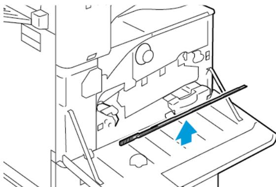
4. Inserire lentamente l'asta di pulizia nel vano di pulizia della lente LED della testina di stampa fino al punto di arresto, quindi estrarre l'asta. Ripetere questa operazione due o tre volte.
