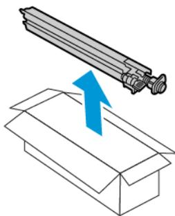
**!** **Attenzione:** non toccare la superficie dell'unità di pulizia della cinghia di trasferimento. Tale azione può causare un deterioramento della qualità delle immagini.
