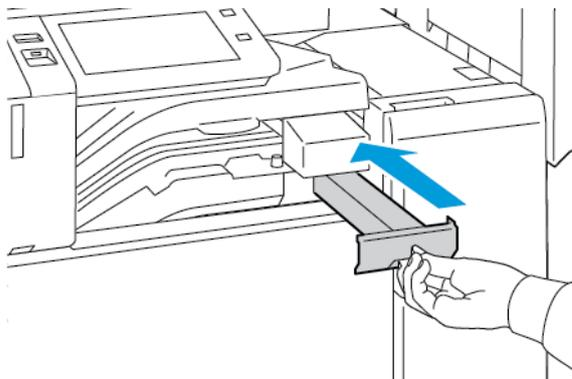
5. Chiudere la copertura dell'area di trasporto anteriore della stazione di finitura, quindi chiudere la copertura superiore.
