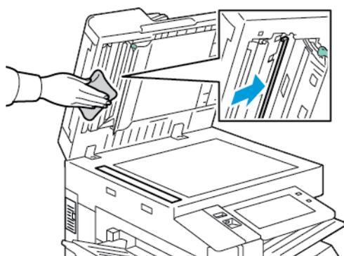
4. Riportare la copertura della lastra nella posizione originaria e assicurarsi che la leva sia bloccata in posizione. Se si tocca la copertura della lastra con le mani, pulire la copertura prima di chiudere l'alimentatore automatico.
