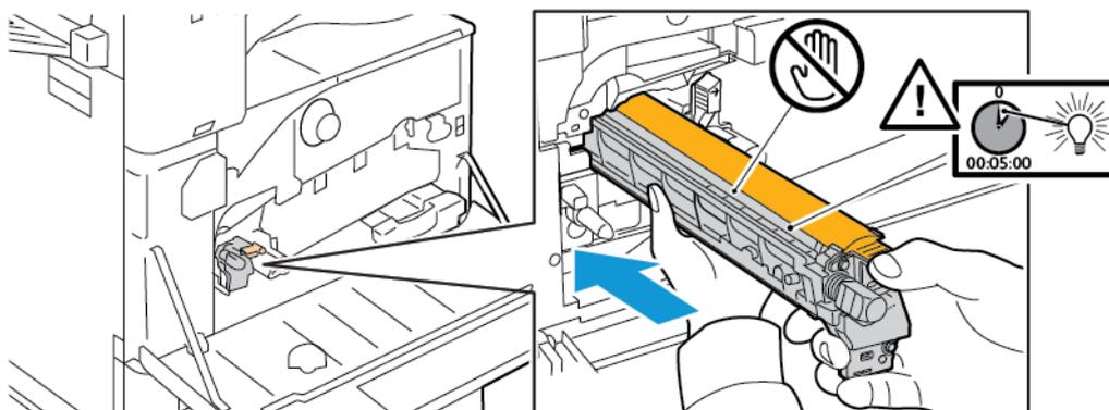
7. Con le guide inserite nell'alloggiamento, rimuovere il foglio di carta nero. Rimuovere il nastro dalla parte superiore della copertura protettiva della cartuccia.
