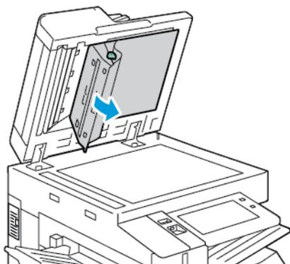
3. Utilizzando un panno morbido non lanuginoso inumidito con acqua, pulire il vetro speculare, la striscia metallica, entrambi i lati della striscia di plastica bianca e i rulli. Se lo sporco non viene rimosso, inumidire un panno morbido con una piccola quantità di detergente neutro, quindi pulire le parti asciutte con un panno morbido asciutto.
