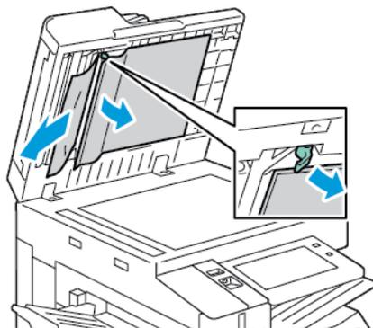
6. Se l'originale non è visibile quando la copertura superiore dell'alimentatore automatico è aperta, chiudere l'alimentatore. Sollevare il vassoio dell'alimentatore automatico e rimuovere la carta inceppata.
