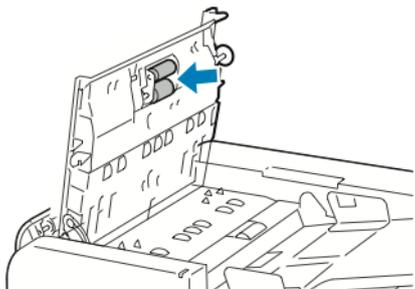
3. Chiudere la copertura superiore dell'alimentatore automatico. Se presente, chiudere la copertura sinistra dell'alimentatore automatico.
