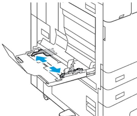
3. Caricare i fogli di intestazione larghi nel vassoio. Caricare la carta sulla guida posteriore dell'estensione con il lato corto alimentato per primo nella stampante. Assicurarsi che il bordo anteriore passi sotto la guida anteriore.
