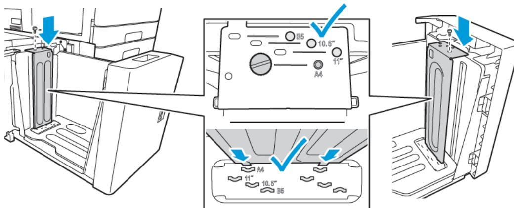
4. Sulla parte superiore dello sportello laterale, sollevare il perno e guidarlo fino al formato carta desiderato nell'apposita fessura. Rilasciare il perno per bloccare il cancello laterale in posizione.
